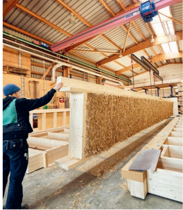
Für Zimmermeister Markus Wolf (links) hat die traditionelle Strohballenbauweise das Potenzial zum «Gamechanger» in der Baubranche. Die mit Strohballen gefüllte Wandscheibe ist fertig und wird per Kettenkran zum Verladen gebracht (rechts).
