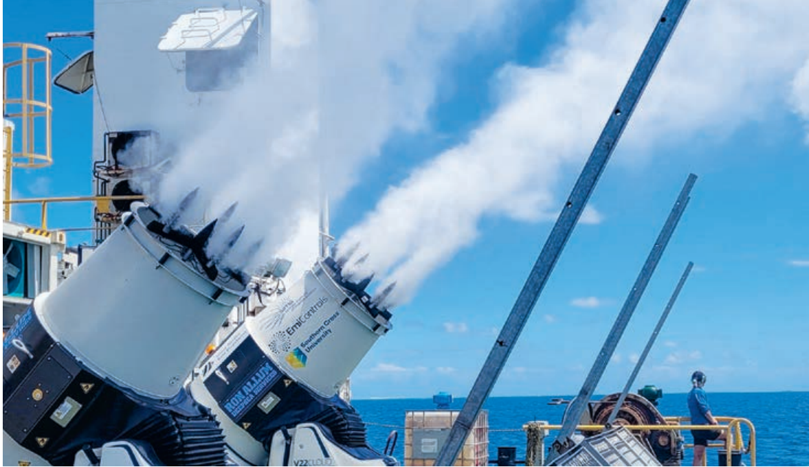
Künstliche Wolken: Wolkenkanonen sprühen mikroskopisch kleine Salzwasserteilchen in die Luft, um Wolken zu bilden, die das Sonnenlicht abstrahlen. * Foto: Southern Cross University
